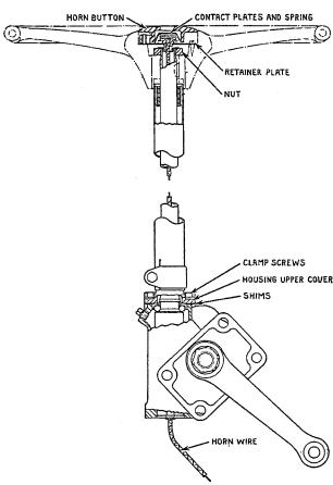
Fig. 1, RT-14, RT-21, RT-26 Steering Gears
